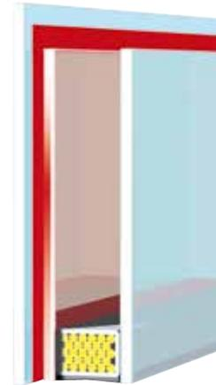
Verbund-Sicherheitsglas besteht auf mindestens einer Seite der Isolierglasscheibe aus zwei durch eine Sicherheitsfolie (oben rot dargestellt) verklebten Glasscheiben. Hierdurch kann diese Konstruktion nicht so zerstört werden, dass ein Durchgreifen oder Eindringen möglich ist.
